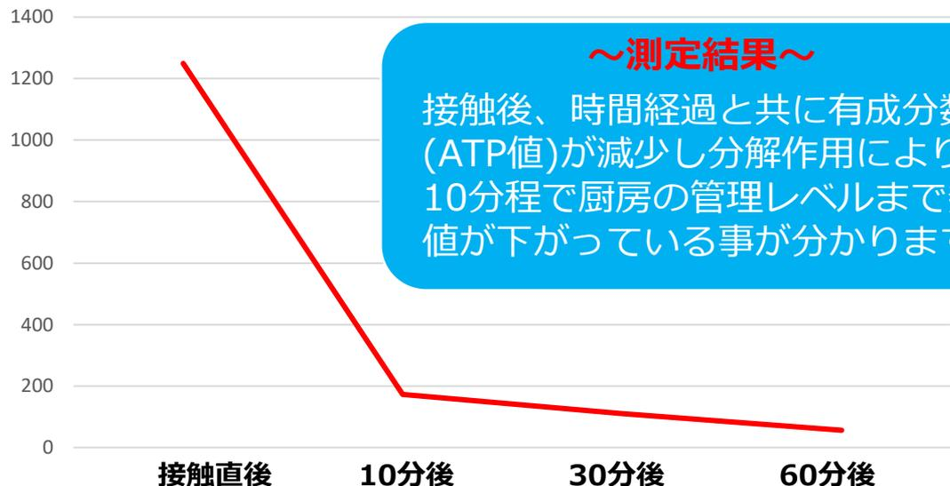
ルミテスター Smart (測定器) によるATP値推移検証
